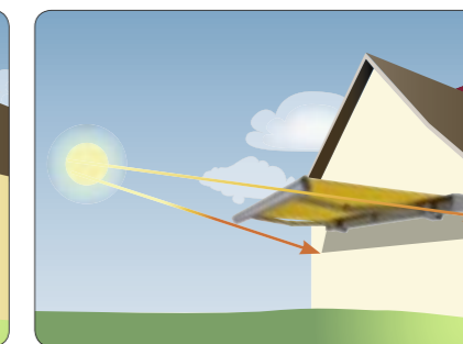
Tiefstehende Sonne z.B.: Westfassade
